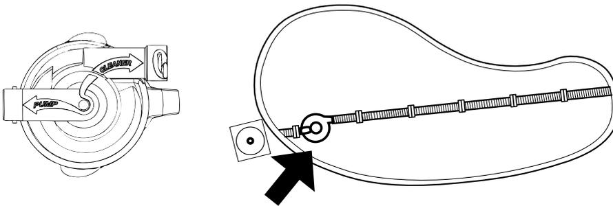
Conecte el prefiltro de hojas a las mangueras más cercanas a la boquilla de aspiración o al skimmer. Asegúrese de que el prefiltro de hojas esté correctamente orientado (pump = lado de la bomba y cleaner = lado limpiafondos).
