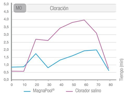
Medición en laboratorio (Zodiac®) del cloro combinado (=cloraminas) después de la combinación con materia orgánica (=MO) en 2 piscinas tratadas respectivamente con cloración salina y MagnaPool®.
