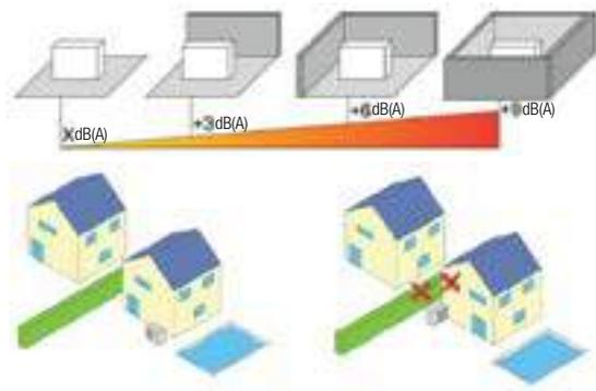
**Para evitar o reducir el ruido hay unas normas de instalación que debemos respetar:**
