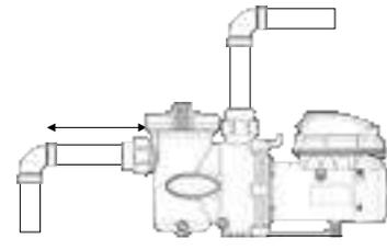
Correcto: la longitud del tubo de aspiración es = 4 x diámetro del tubo (20 cm para DN50 y 25 cm para DN63).
