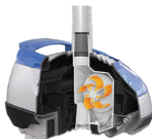
Tecnología patentada V-Flex™: turbina de álabes móviles para capturar los residuos grandes
