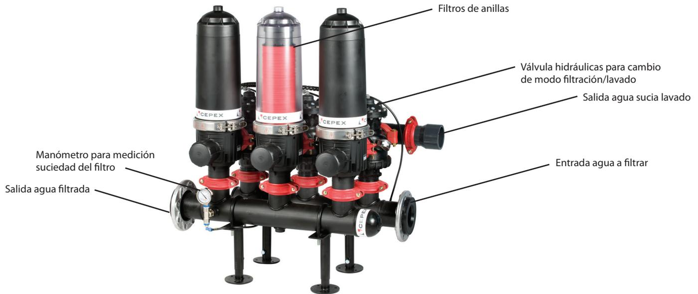
**Limpieza:** El proceso de lavado de los filtros se efectúa en un sólo filtro, mientras el resto siguen en fase de filtración, manteniendo el equipo en funcionamiento en todo momento.
