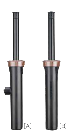
[A] PROS-06-SI-PRS30 [B] PROS-06-PRS30 Altura retraído: 22 cm Altura emergente: 15 cm Diámetro expuesto: 5,7 cm Conexión: ½"
