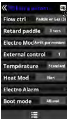
Aller dans le menu Flow ctrl et sélectionner Palette (2). Appuyer sur OK pour valider la sélection. Par défaut, le boîtier est sur Paddle or gas (3).
