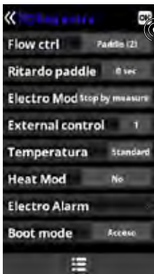
Andare nel menu Flow ctrl e selezionare Paddle (2). Premere OK per confermare la selezione. Di default il pannello è su Paddle o gas (3).
